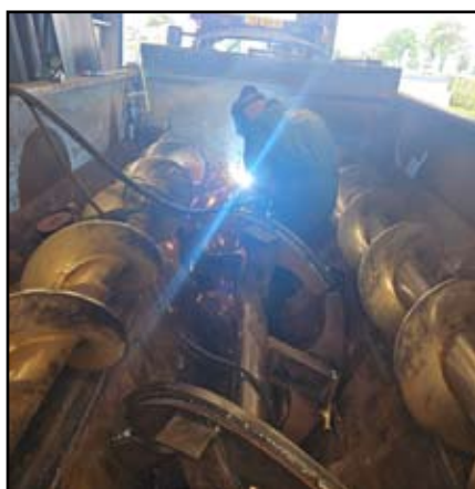
Reparatie mengwagen. De mengas is gerepareerd en er zijn nieuwe schoepen aan gelast met slijtplaten.
