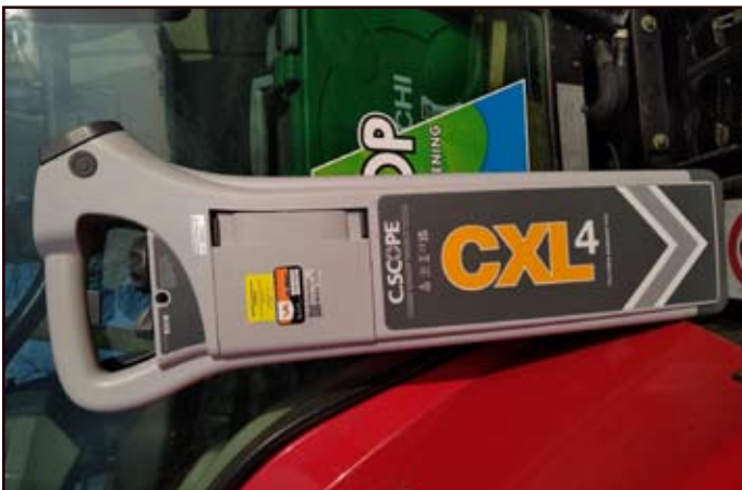
Kabelzoeker C.Scope CXL4, 14 september 2023.
