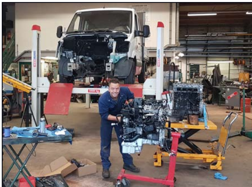
Reparatie auto door Mike Roozendaal. Er wordt een andere motor gemonteerd.
