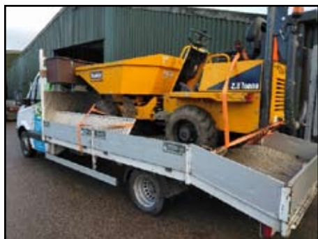
Oprijplaten ook vastgezet.
