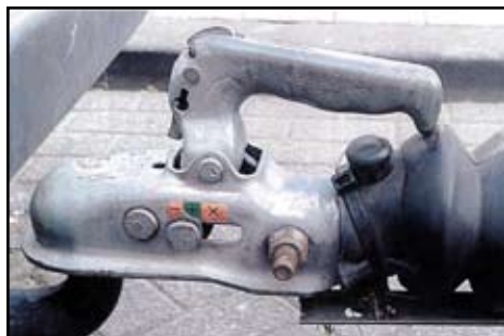
Foto: wijzer staat nog in het groene vak, de kogel zit correct op de haak.
