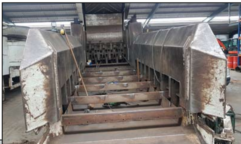
Reparatie Diamond. Nieuwe vloer en draagbalken vervangen.
